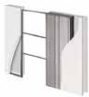
Parede de Gesso Cartonado Pared en cartón-yeso
