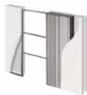
Plasterboard wall Mur en plaque de plâtre
