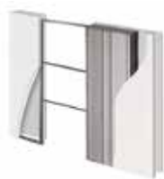
Parede de Gesso Cartonado Pared en cartón-yeso
